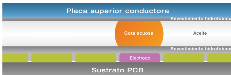
Figura 1 Sección transversal de la tarjeta de biblioteca (vista lateral)
