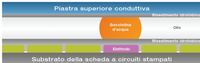
Figura 1 Spaccato di una scheda delle librerie - vista laterale
