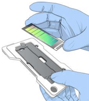
Фигура 19 Зареждане на BeadChip на адаптера
