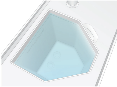
그림 29 MIN FILL VOLUME 표시선까지 채워진 중앙 웰
