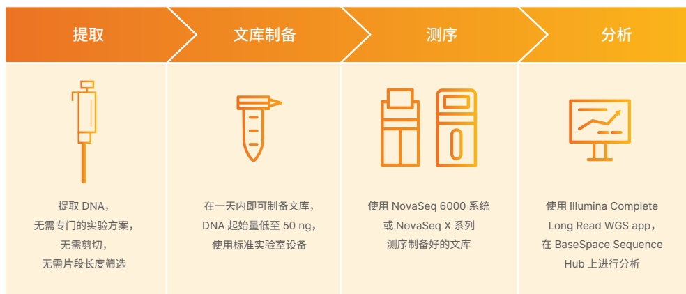
图 1: Illumina Complete Long Read 工作流程——采用可扩展、优化的文库制备方案, 使用 NovaSeq 6000 系统或 NovaSeq X 系列进行测序, 结合 DRAGEN 分析, 可获得全面的 WGS 长读长数据。标准的 30×WGS 文库应制备、测序, 并和 Illumina Complete Long Read 文库一起分析
