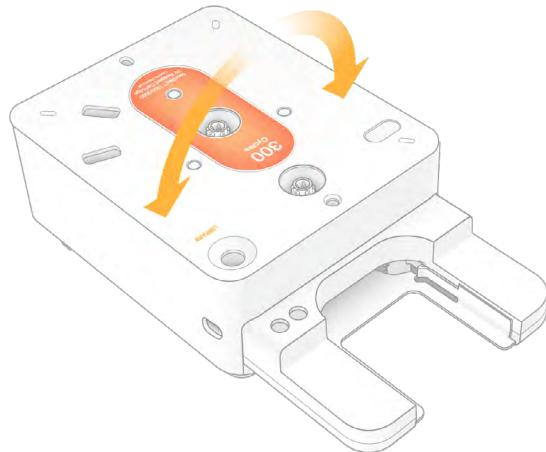
3. [XLEAP-SBS Chemistry] 평평한 표면 위에 카트리지를 올려놓습니다. 그림과 같이 평평한 표면 위에 올려둔 카트리지의 암(arm)을 잡고 약 4~7 cm 들어 올렸다가 손을 놓아 카트리지를 표면에 부딪혀 줍니다. 이를 5회 반복합니다.
