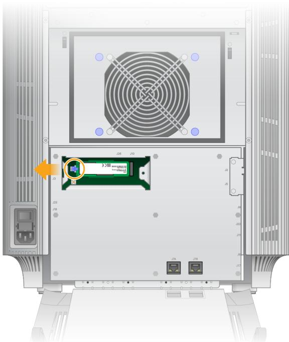
f. 一旦取出第一个 SSD，第二个 SSD 将会露出。按下卡舌释放第二个 SSD，并将其拉出。
